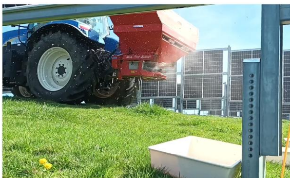
Photo 2 : Vue de la projection de l'engrais par l'épandeur et récupération des billes dans des bacs répartis de manière transversale dans l'inter-rang pour évaluer la distribution spatiale de l'engrais.
